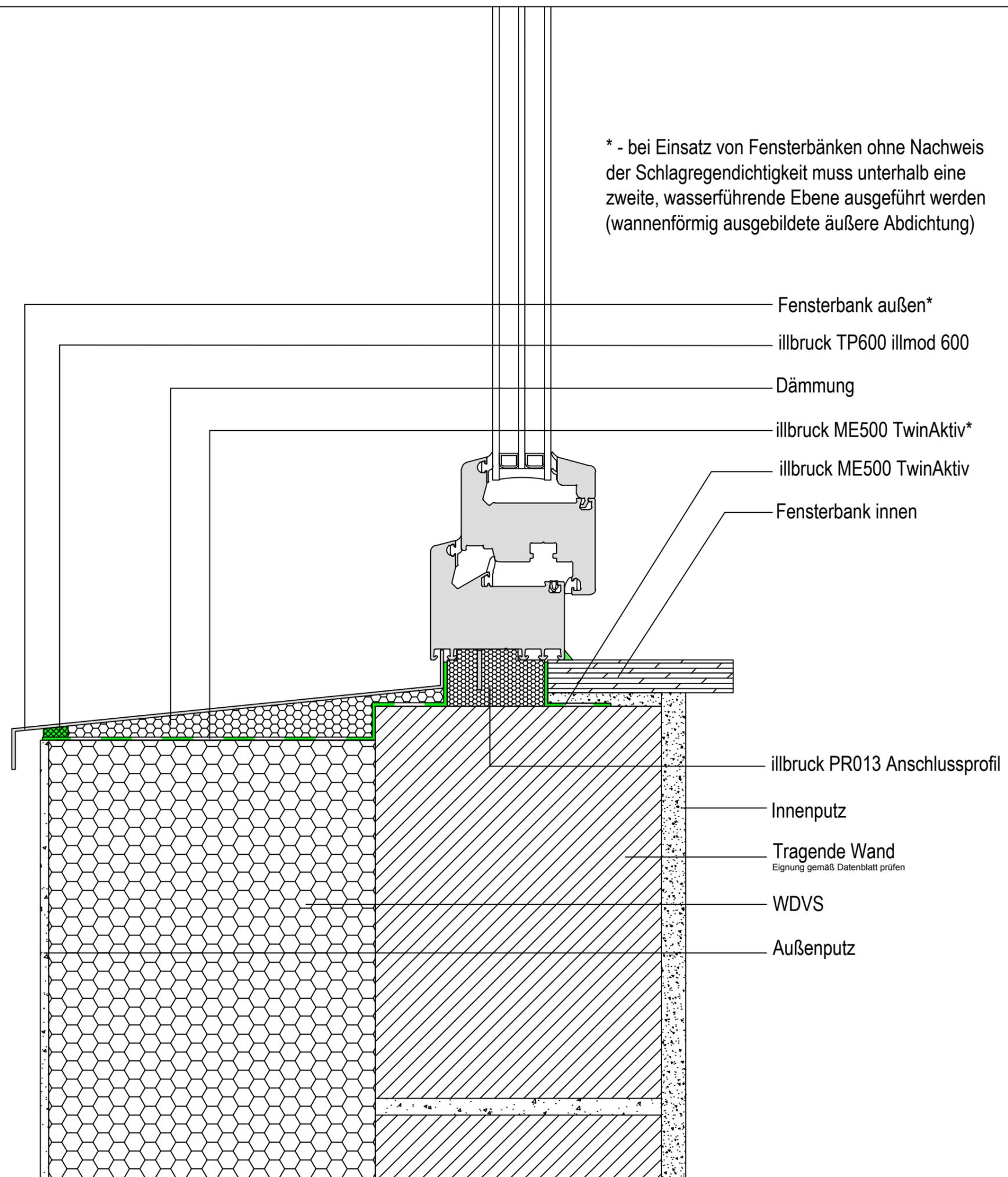
\* - bei Einsatz von Fensterbänken ohne Nachweis der Schlagregendichtigkeit muss unterhalb eine zweite, wasserführende Ebene ausgeführt werden (wannenförmig ausgebildete äußere Abdichtung)
