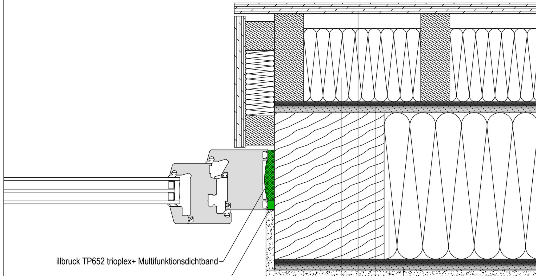
illbruck TP652 trioplex+ Multifunktionsdichtband
