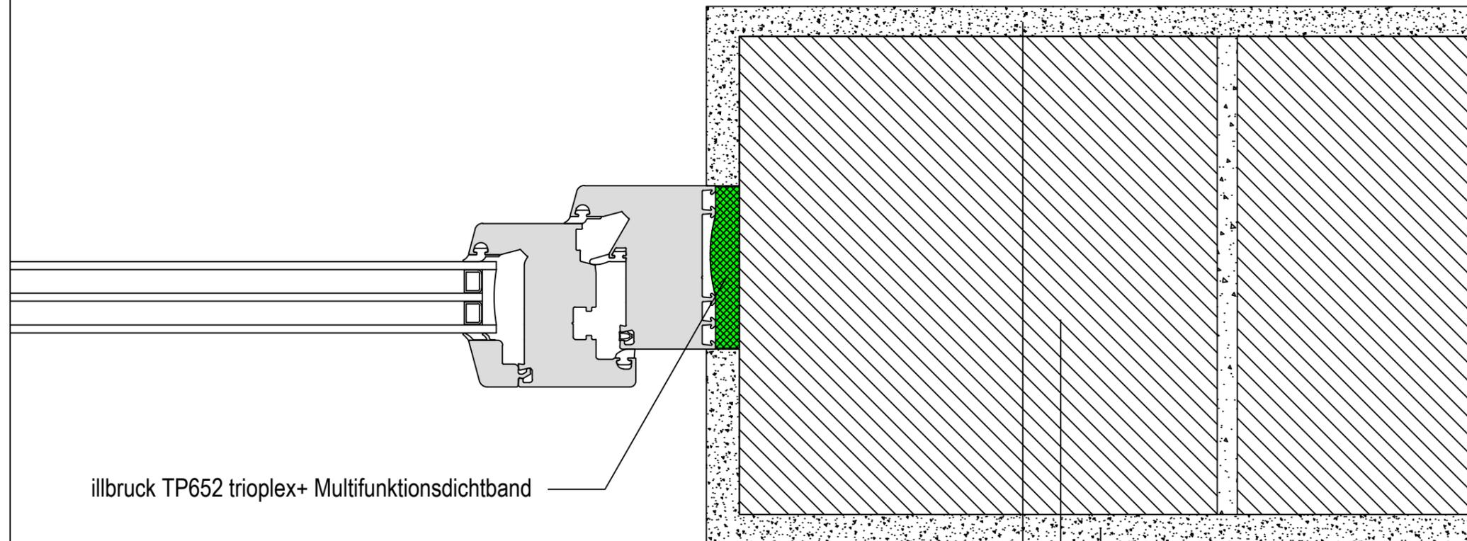
illbruck TP652 trioplex+ Multifunktionsdichtband
