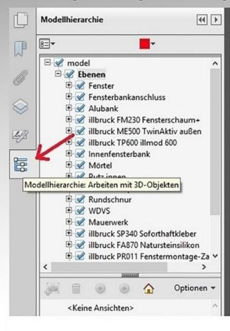
Bei Klick auf dieses Struktursymbol (roter Pfeil) öffnen sich die Ebenen und die einzelnen Bauteilbezeichnungen werden angezeigt. Sie können die einzelnen Bauteile im 3D-Modell auch direkt anklicken, so dass diese in der Modellhierarchie markiert werden. Durch Klick auf die blauen Häkchen können einzelne Bauteile ein- und ausgeschaltet werden.
